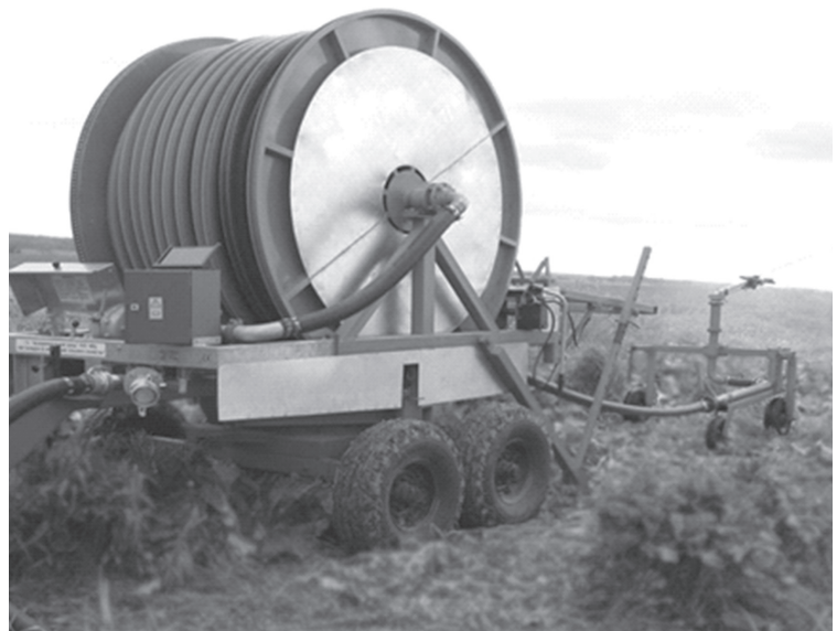
Рис. 3. Дождевальная установка УД-2500
